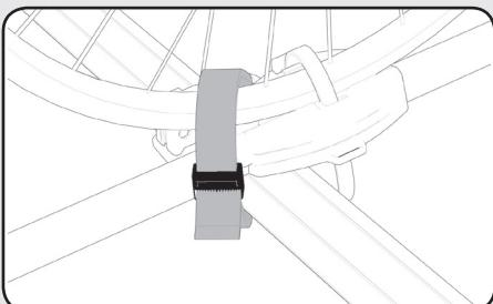
**Es posible sujetar la bicicleta al portabici mediante una correa de seguridad.**
