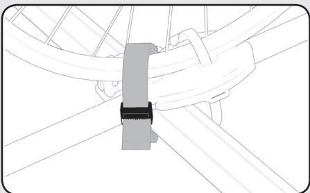
**Per la Vostra maggiore sicurezza è possibile fissare la bicicletta al portabici mediante un ulteriore cinghia di sicurezza.**
