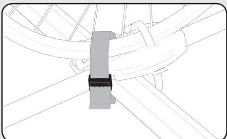
Pour une plus grande sécurité, il est possible de fixer le vélo au porte-vélo à l'aide d'une autre courroie de sécurité.
